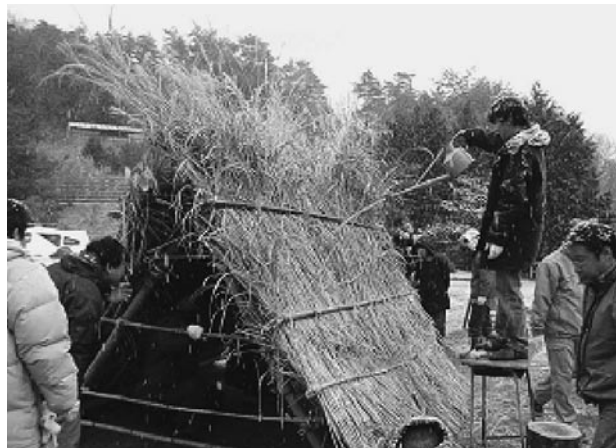
写真8 薄葺きの茅でも中には漏らない
